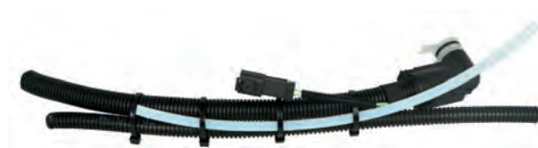
Fig. 54 : Fixer la conduite d'air avec l'attache-câble
