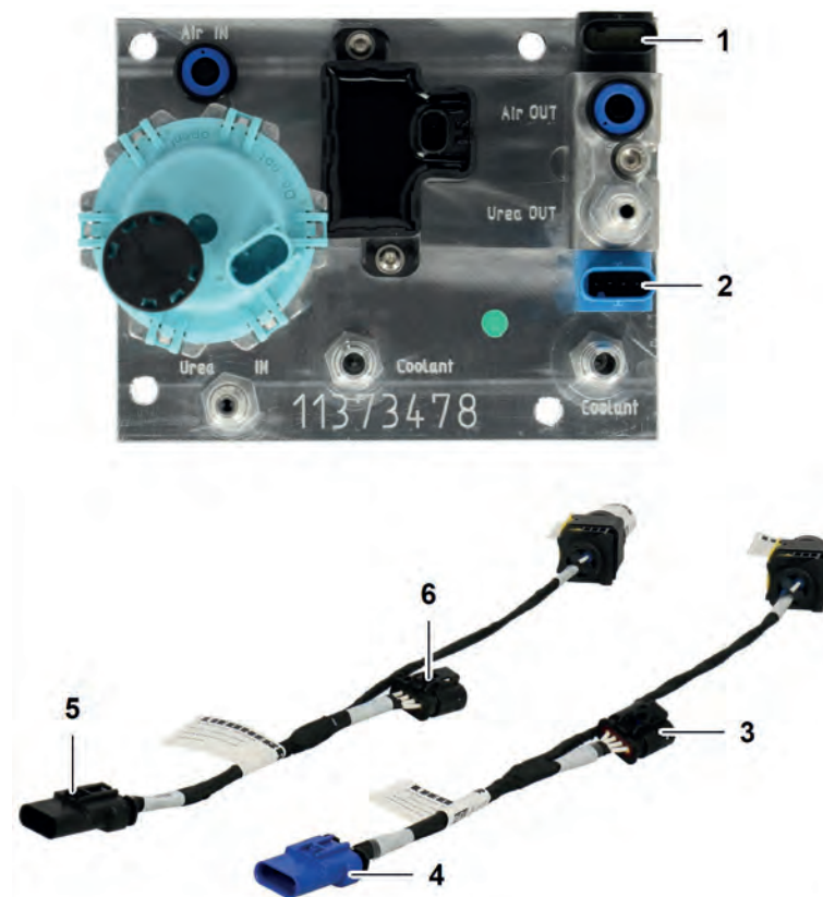
Fig. 66 : Pompe à urée et jeu de câbles
