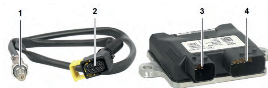
Fig. 70 : Appareil de commande NH3 avec capteur NH3
