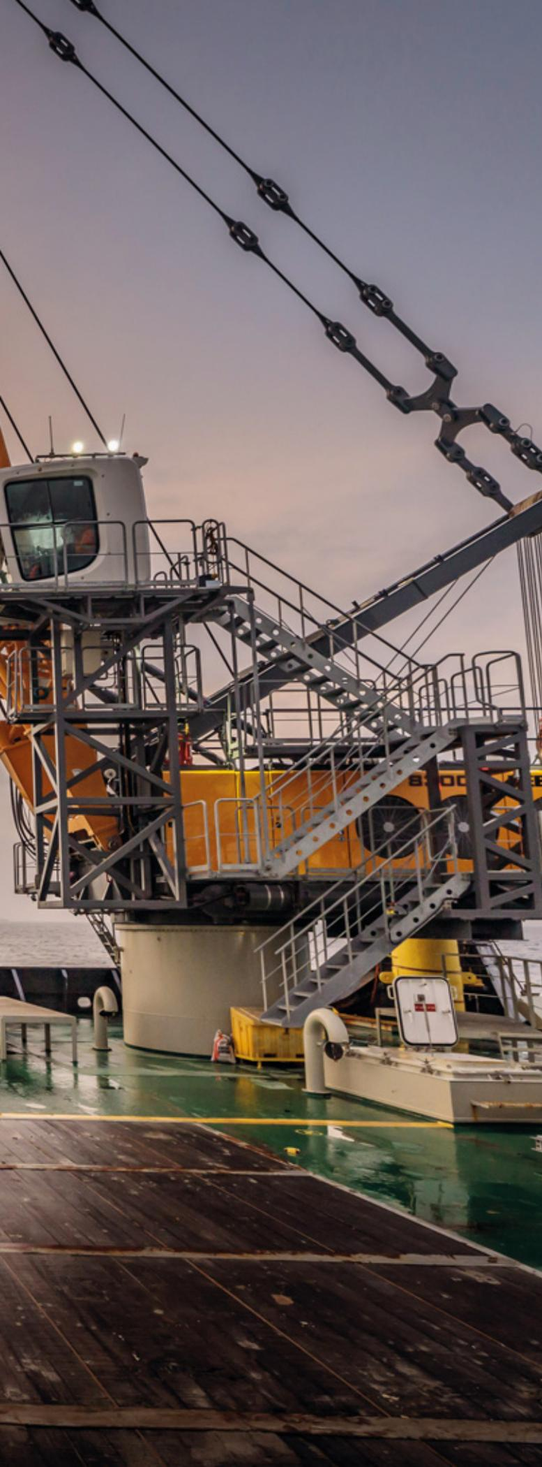
Mit einem Einsatzgewicht von 350 Tonnen zählt der HS 8300.2 von Liebherr zu den größten Hydroseilbaggern. Er kann mit verschiedenen großvolumigen Schleppschaufeln und Greifern ausgestattet werden.
