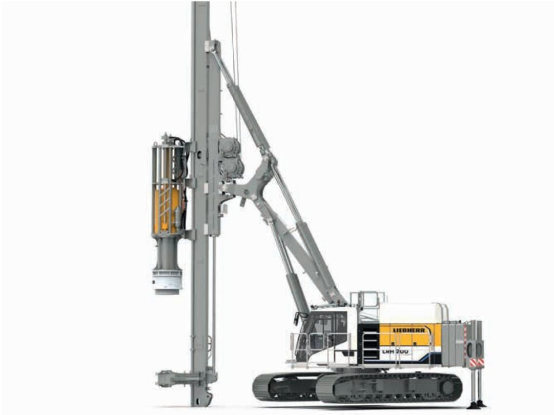
Durch Abstützen des Mäklers auf dem Boden und Ausfahren der Heckabstützzyylinder wird das Trägergerät angehoben. Der Unterwagen kann nun in der Luft gedreht werden, was bei beengten Platzverhältnissen das Bewegen des Rammgerätes erleichtert.
