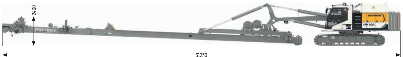
Für Wartungs- und Servicearbeiten an Mäkler und Trägergerät kann der Mäkler nach vorne abgelegt werden. Ein Bewegen/Verfahren des Rammgerätes ist in dieser Position nicht möglich.
