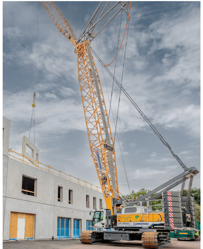
The battery-powered LR 1250.1 unplugged carrying out lifting work in Malmö (Sweden) الرافعة LR 1250.1 unplugged التي تعمل بالبطارية تقوم بأعمال الرفع في مالمو (السويد)
