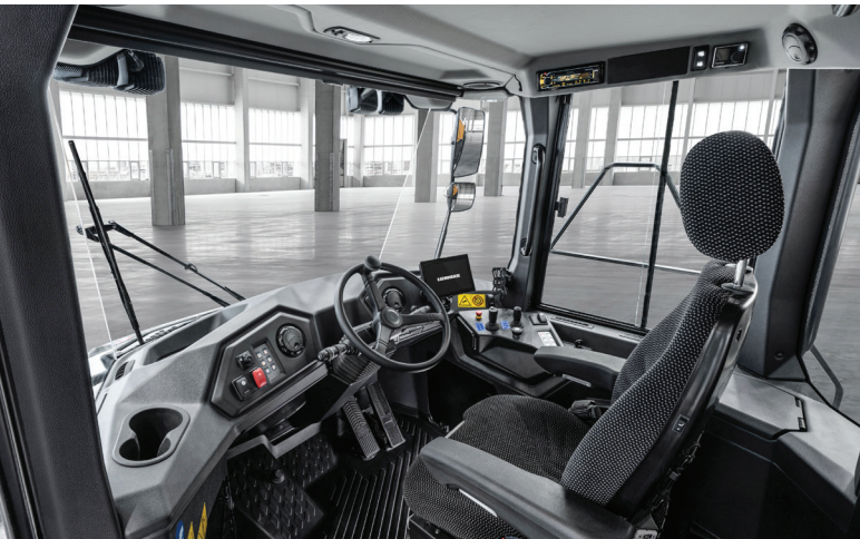
The modern operator's cab of the TA 230 Litronic كابينة المشغل الحديثة للمعدة TA 230 Litronic
