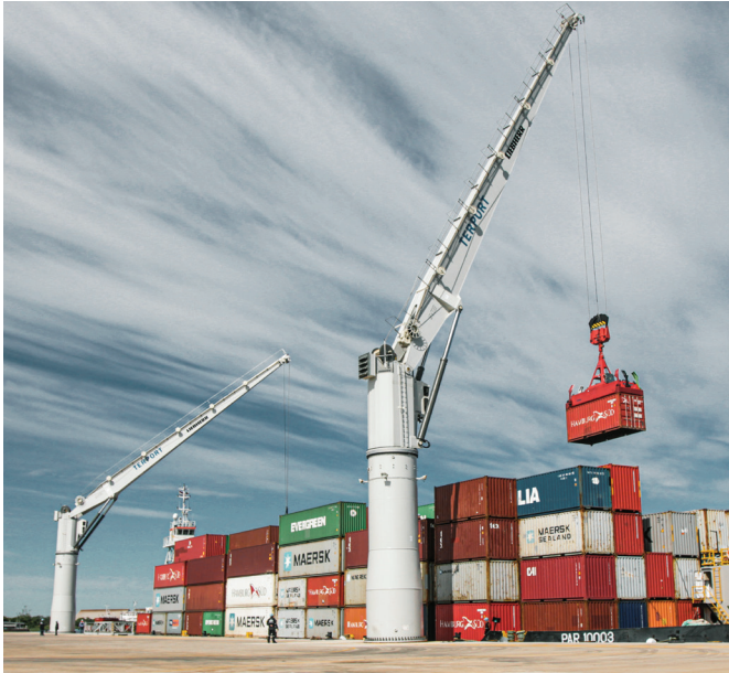
An FCC 280 fixed cargo crane handling containers in San Antonio (Paraguay) رافعة البضائع الثابتة FCC 280 أثناء مناولة الحاويات في سان أنطونيو (باراغواي)
