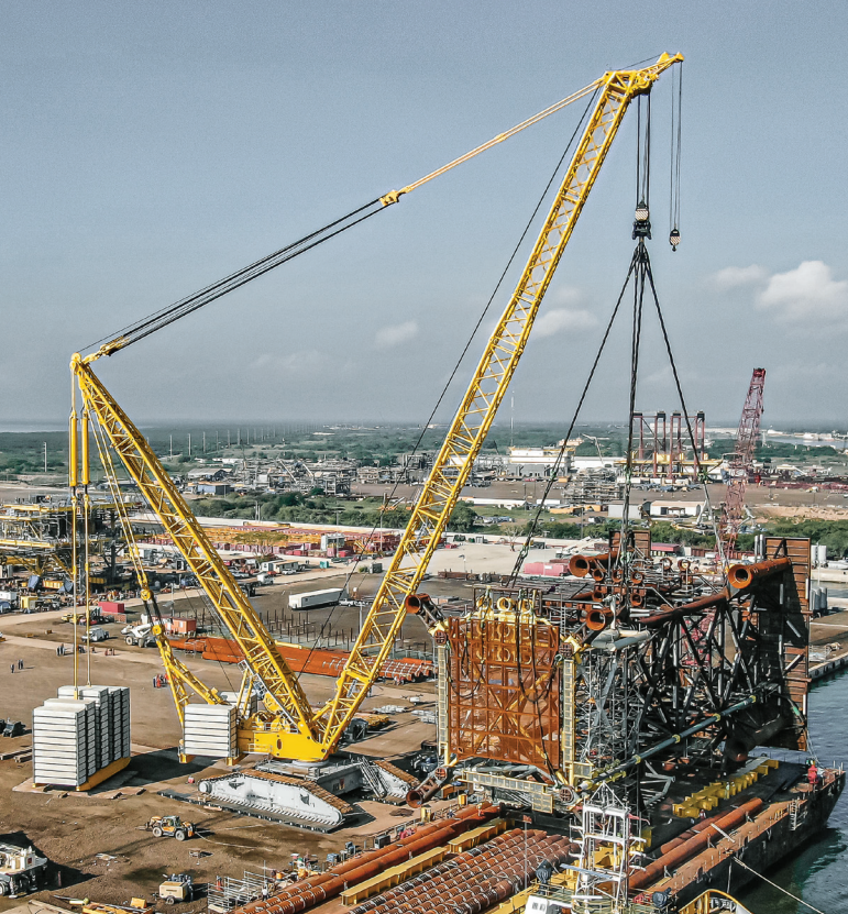
The LR 13000, the world's strongest conventionally designed crawler crane, loads vast oil platforms in Mexico. الرافعة المجنزرة LR 13000. الأقوى عالمياً من حيث التصميم التقليدي. تقوم بنحمل منصات النفط الضخمة في المكسيك.
