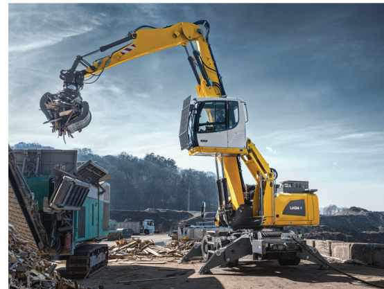
The LH 26 M Industry E in recycling operation المعدة LH 26 M Industry E أثناء عمليات إعادة التدوير
